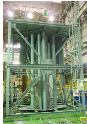
図7-3 ACSモックアップ1/3炉心を対象としてモックアップにより配管配置及び施工性について確認し、設計製作に係る知見を獲りました。
