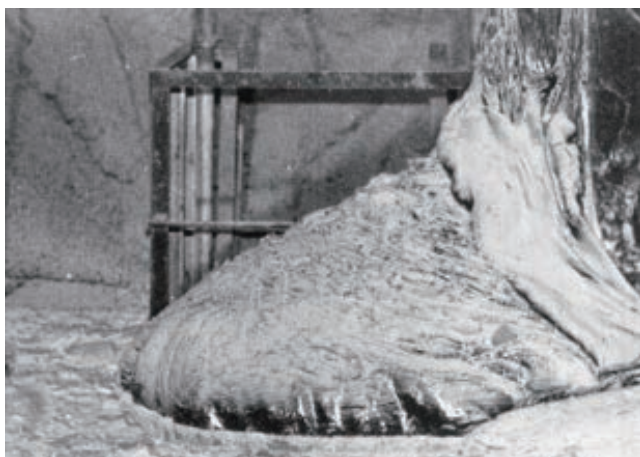
図1 チョルノービリ事故発生直後に確認された「象の足」*1 1986年に発生した事故により生成した、象の足のような形状の燃料デブリです。放射能が非常に高く、コンクリート成分を多く含んだ、非常に硬いガラス状の黒い溶岩状物質でした。
