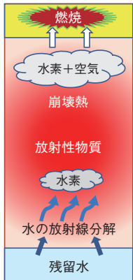
図1 放射性物質を保管する容器の内部の概念図
