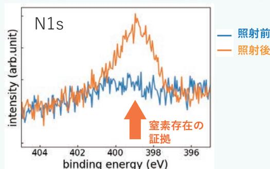
窒素系ガス分子ビームにより窒化反応を実現
