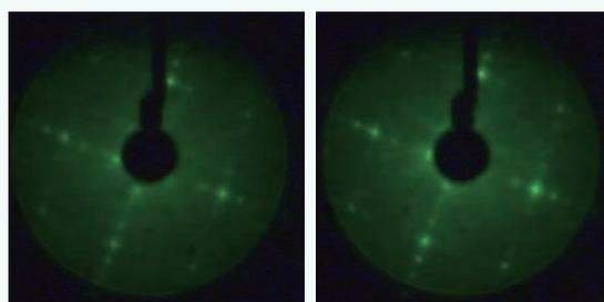
電子線回折パターンが不変：表面構造を保持した窒素ドーピング
