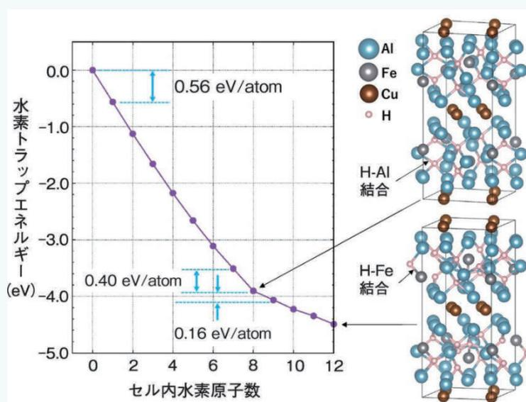
$Al_7FeCu_2$ 化合物のアルミ合金中における水素吸収能：水素原子のトラップエネルギー(eV/atom)は水素吸収量の増加に伴い小さくなるものの、セル内で約8個まで吸収可能と期待される。
