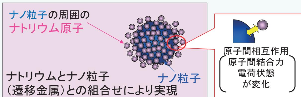
ナノ粒子の周囲にアルカリ金属（ナトリウム）が原子間結合を起こし、強く結合している。
