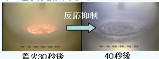
ナノ粒子分散ナトリウムは燃焼温度が低下し、燃焼が早く終わり反応抑制効果が現れている。
