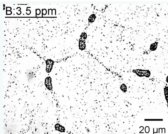
α線トラック法によるステンレス鋼中のホウ素分布(黒点1個1個がαトラックの軌跡を示している)
