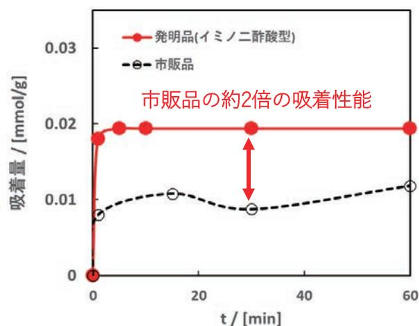
有機溶媒<sup>※1</sup>中の Zr に対する吸着性能<sup>※2</sup>
