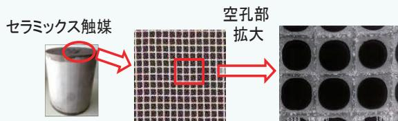
優れた触媒性能、耐熱性を有する自動車用排気ガス浄化用セラミックス触媒（ダイハツ工業製インテリジェント触媒）を改良
