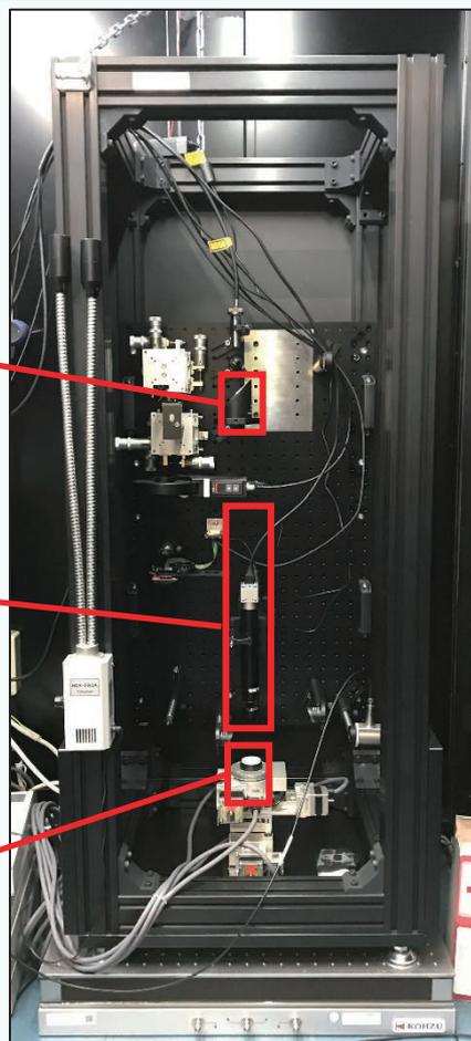
白色レーザー光源を用いたミラー光学系で反射分光分析が可能になる。
