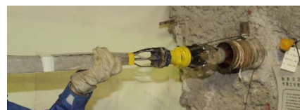
発振子としての孔内起振源の ボーリング孔内への挿入の様様
