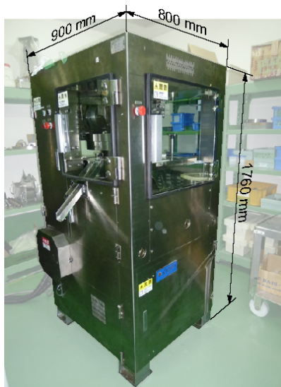
図1 回転式粉体圧縮成型機(試験機)の外観
