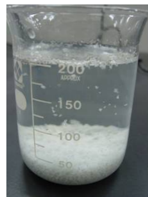
電解凝集法によりセシウムを凝集・沈殿させた例
