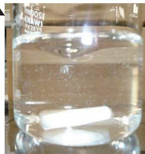
フェロシアン化物沈殿が水中の放射性セシウムを吸着します。
