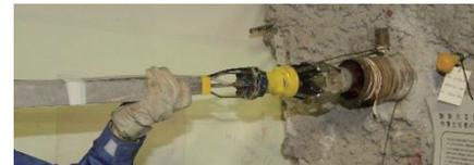
発振子としての孔内起振源のボーリング孔内への挿入の様相
