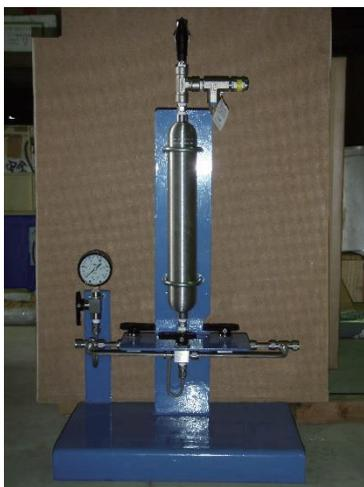
定圧弁や脱ガス確認用のアキュムレータタンクを備えており、脱ガスの有無や溶存ガス量を確認できます。
