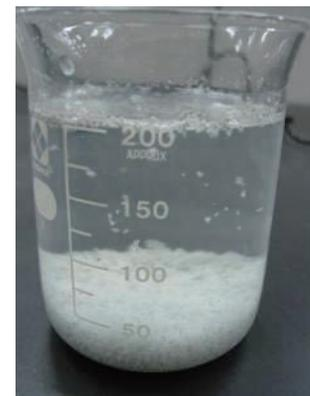
電解凝集法によりセシウムを凝集・沈殿させた例
