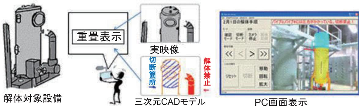
2. レーザーレンジファインダでスキャンすることで解体撤去物及び敷設設備の三次元形状モデルを作成し、運搬時に敷設設備との干渉状態や仮置きイメージを表示することができます。
