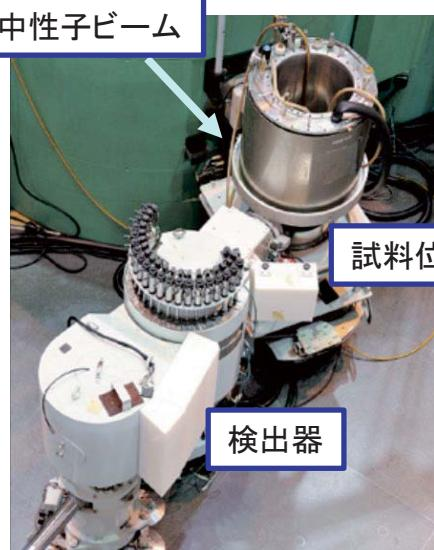
中性子散乱実験装置の例
