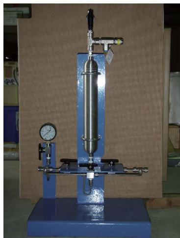
定圧弁や脱ガス確認用のキュムレータタンクを備えており、脱ガスの有無や溶存ガス量を確認できます。
