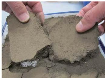
PICの散布で土壤を固化し、土木工事での粉塵の発生や雨による流出を防止
