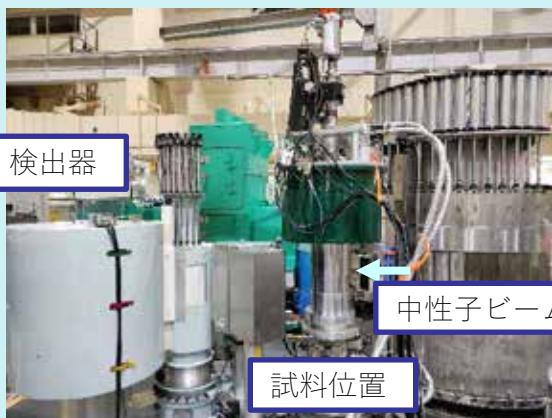
中性子散乱実験装置の例。
