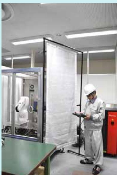
レーザー光の減衰層とシート自体が容易に損傷しないよう一般的な溶接作業などに用いられるスパッタシート同等の性能を有する耐熱・耐炎層を張り合わせた3層構造
