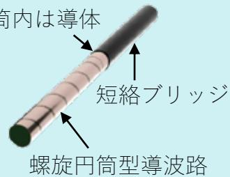
導波路と短絡ブリッジから構成される可変共振器により広帯域にわたって共振周波数が調整可能
