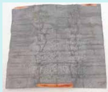
$^{60}\text{Co}$ 線源を用いて、 $\gamma$ 線遮蔽能を測定した結果、7mm厚で15%の遮蔽率を達成
