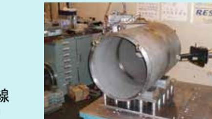
直径500mm、厚さ28mm溶接配管
