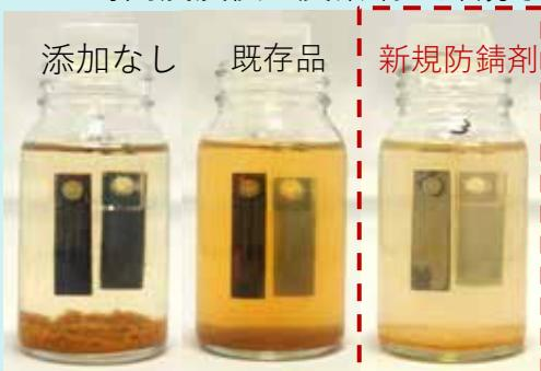
100時間浸漬後の炭素鋼の腐食減量
