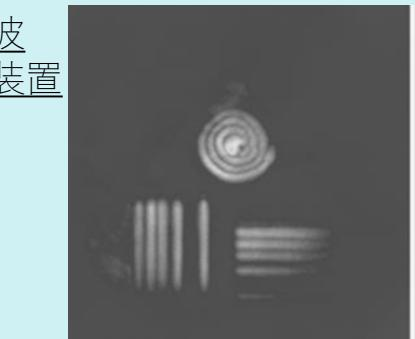
本超音波検査装置による可視化の例
